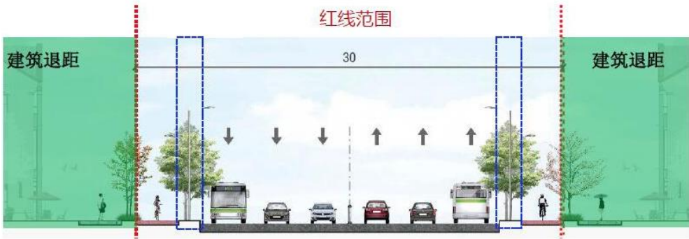
图 6-61 慢行空间与建筑退距一体化设计图
